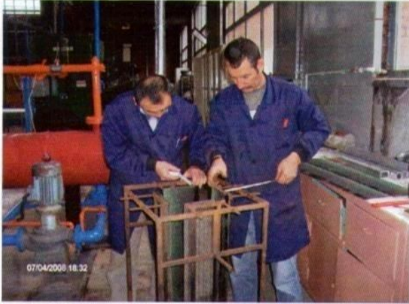
Deneyde kullanılan standart DIN 4102' dir ve yapılan deney ürünün B1 -zor alev alan- olup olmadığının tayinidir.
